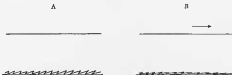
FIG. 94. — Rôle du mode de recouvrement des écailles ventrales dans la variation du coefficient de frottement.
